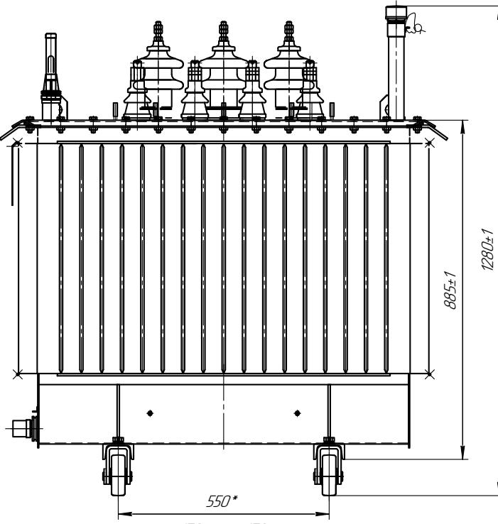
Ширина колеи катков при продольном и поперечном перемещении трансформатора
